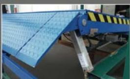
Uno speciale sistema di blocco permette la messa a punto e/o la manutenzione della pedana in completa sicurezza.
